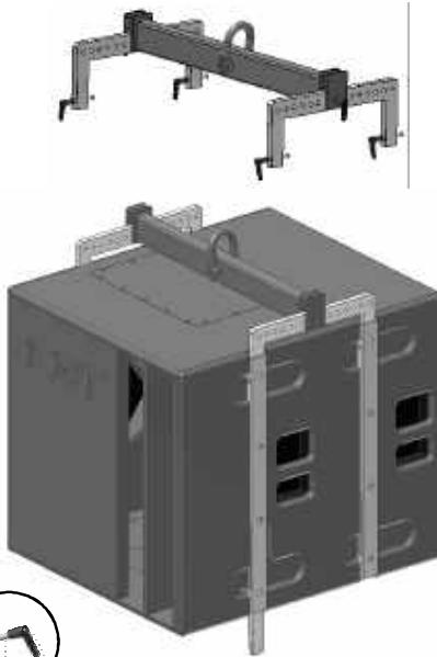
Les modèles MODUS utilisent un système de suspension incorporé dans la structure de base. Le seul élément qui doit être ajouté pour la réalisation d'un array est la barre de suspension (barre volante): celle-ci doit être accrochée au système à l'aide d'un joint de 90° (configuration avec SATELLITE en position élevée) ou bien avec un joint en U (configuration avec SUB en position élevée).
